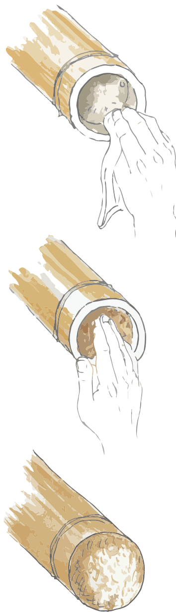
Figura 59. Proceso para sellar extremos
