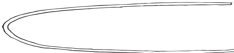
Figura 42. Dobles de varilla corrugada.
