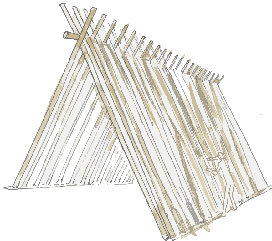
Figura 8. Blanqueamiento del bambú sobre el "burro".
